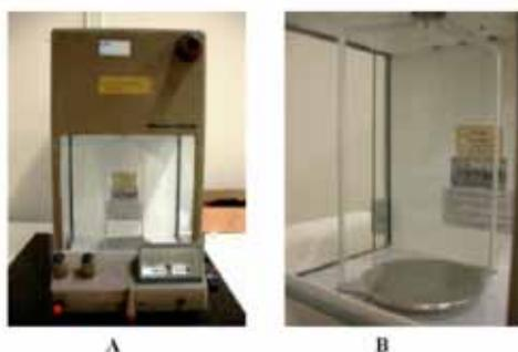
Figura 3.1 – Balança analítica (A) e detalhe do prato da balança (B)
